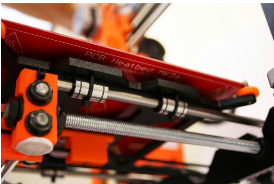
Pilt 23 – korralikult pingutatud kaablivitsad kuumaluse all
