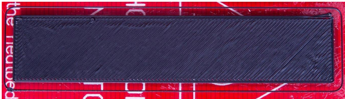
Pilt 6b – kalibreeritud printer moodustab ühtlaseid filamendi kihte.
